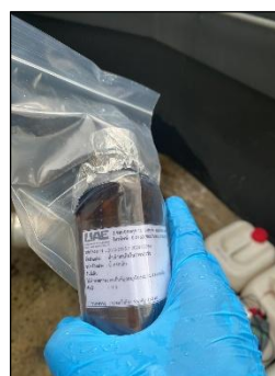
การติดตามตรวจสอบคุณภาพน้ำที่เข้าหอผึ่งเย็น น้ำเข้ามาเติมในอ่างรองรับ
